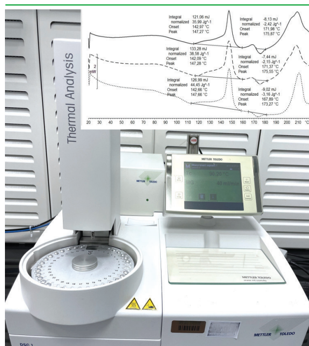
Slika 1: Primer aparature za dinamično diferencno kalorimetrijo in izpisa termične analize. Vir fotografije: arhiv podjetja Krka, d.d., Novo mesto.
