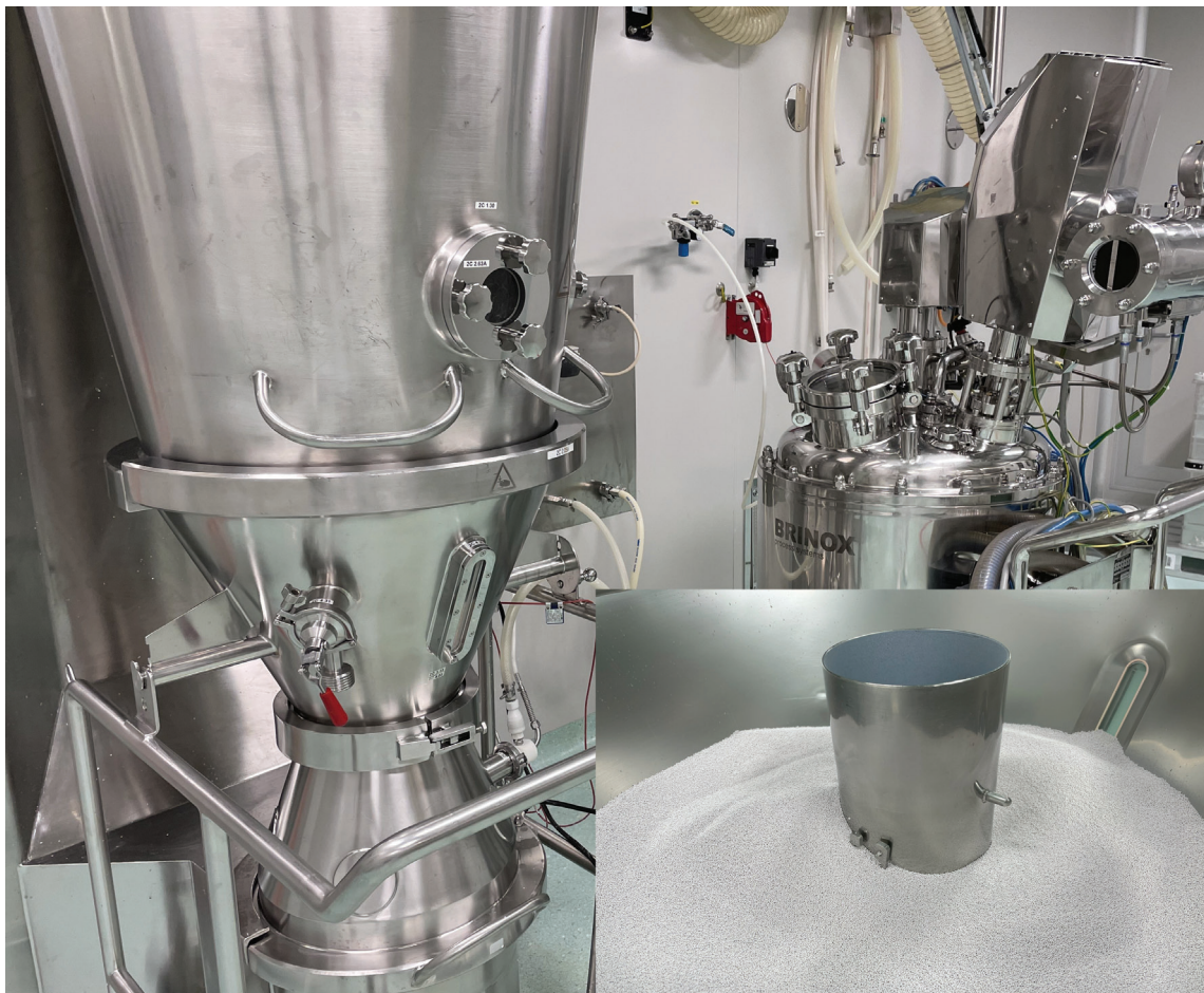
Slika 2: Primer oblagalnika pelet (polindustrijska oprema). Vir fotografije: arhiv podjetja Krka, d.d., Novo mesto. Figure 2: Pelet coater (semiindustrial scale). Photo from the archive of company Krka, d.d., Novo mesto.
