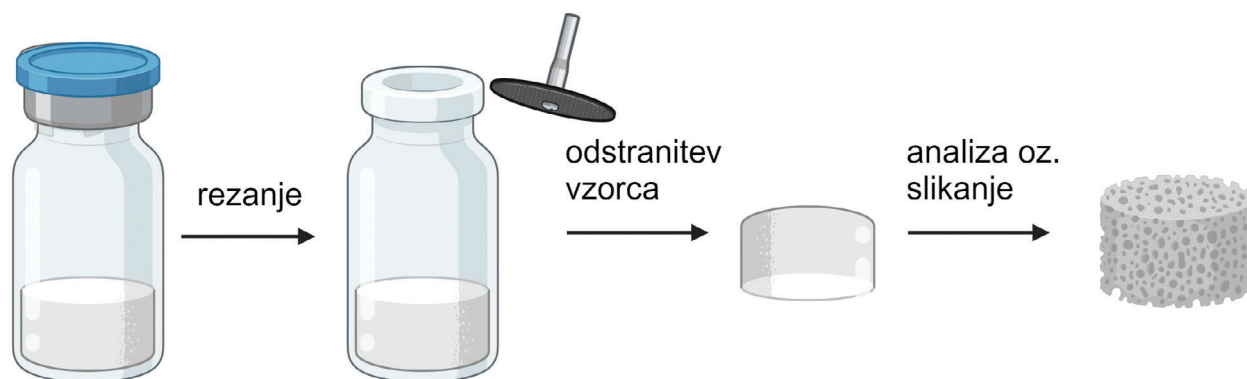
Slika 2: Postopek tridimenzionalnega laserskega slikanja liofilizata. Povzeto po (7). Slika je bila izdelana s programom Biorender. Figure 2: Procedure for three-dimensional laser imaging of lyophilisates. Adapted from (7). Created in Biorender.
